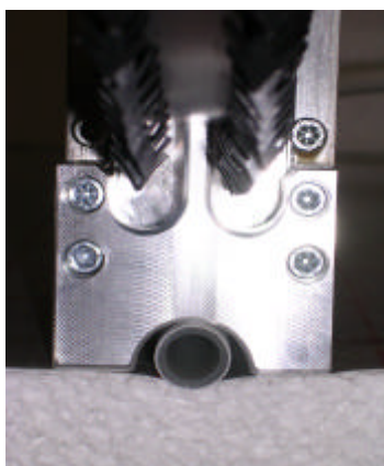
5. Alu-Setzstock mit richtig aufgesetzter Rohrführung des Setzstockfußes
