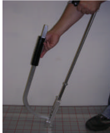
2. Magazinstange des Alu-Setzstockes mit magazinerten Heizrohrhaltern bestücken
